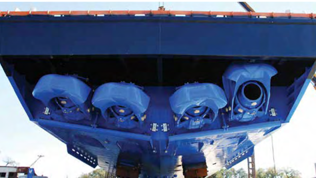
上／下：クルーボート「Aaron McCall」は HamiltonJet の HT900 ウォータージェット（4基）を初めて搭載した船である。
